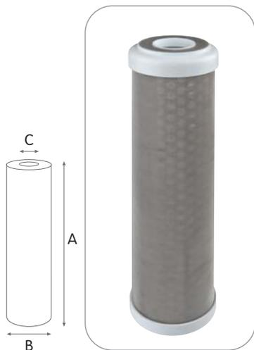
Cartucce in rete di acciaio inox e armatura interna con elevata portata e bassa caduta di pressione, filtrazione nominale standard 70 micron.
