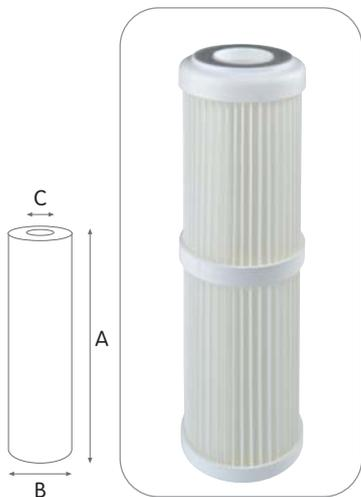
Cartucce in tessuto plissettato con ampia superficie filtrante, filtrazione nominale 50 micron. Elevata portata e bassa caduta di pressione. Altezza da 4" a 20".
